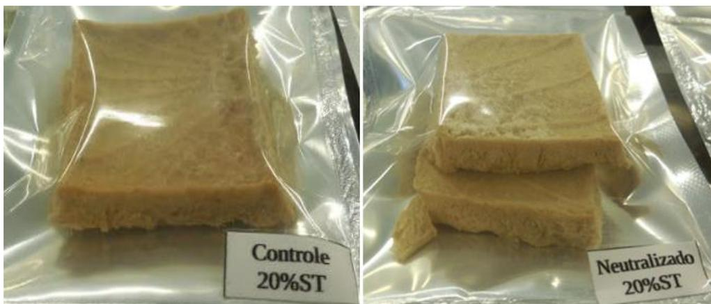
Considerando o rendimento de pó por batelada, optou-se por trabalhar com a polpa com 20% de sólidos em um programa de 53 horas, seguindo os parâmetros do processo (b), aplicado para a liofilização da polpa de tamarindo controle (pH 2,5) e neutralizada (pH
