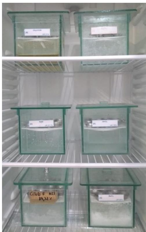
O processo foi acompanhado por pesagens das amostras a cada 24 horas até atingirem o equilíbrio. Posteriormente, foi medida a atividade de água em aparelho aqualab modelo 4 TEV, nas temperaturas de 25 e 40 °C. Em seguida, cada cadinho foi pesado e levado à estufa (105 °C) para determinação da massa seca de cada amostra.
