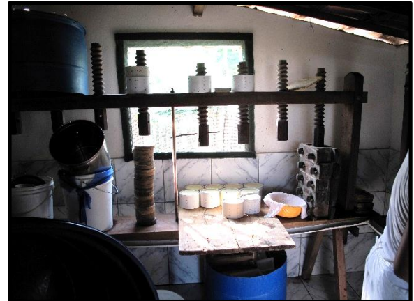
Imagem 3 - Prensas de Madeira para queijo coalho, com formas redondas feitas de madeira e/ou canos de pvc
