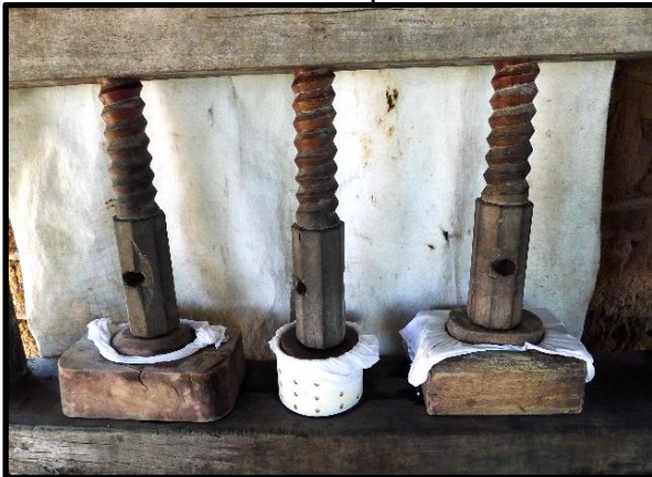
Imagem 3 - Prensas de Madeira para queijo coalho, com formas redondas feitas de madeira e/ou canos de pvc
