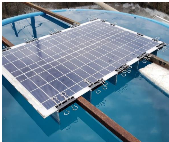
Figura 28 – Módulo FV com aletas em sua superfície posterior sobre tanque d'água.
