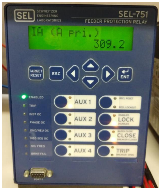
Figura 28 - Painel frontal do IED 1 (SEL 751).
