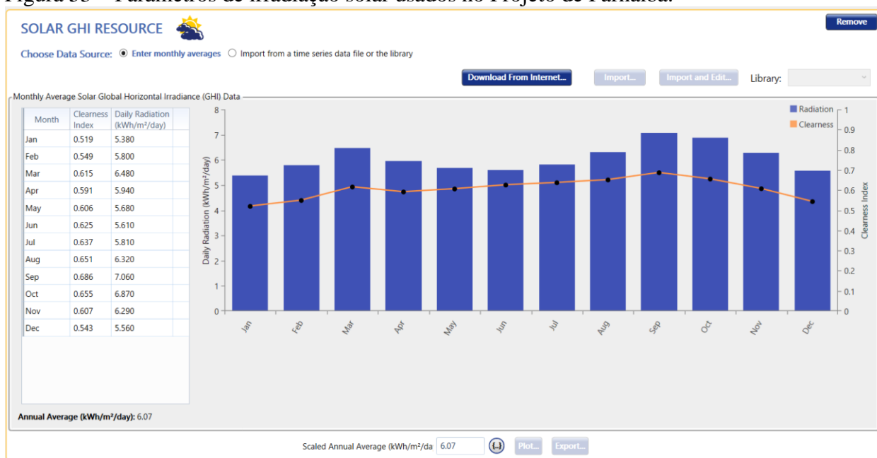
Figura 53 – Parâmetros de irradiação solar usados no Projeto de Parnaíba.
