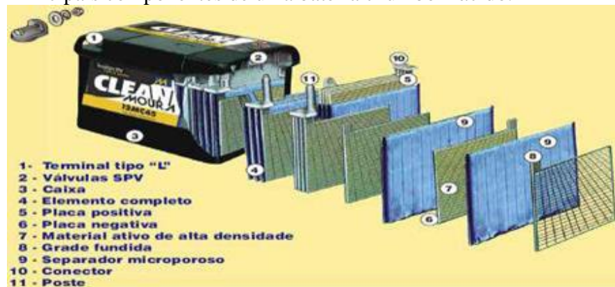
Figura 11 – Principais componentes de uma bateria chumbo – ácido.
