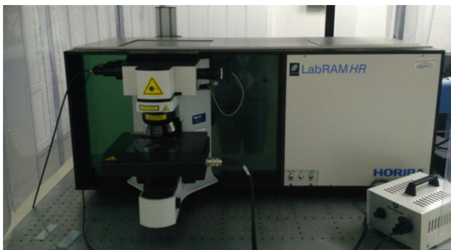
Figura 3.2: Espectrômetro utilizado para a realização das medidas.
