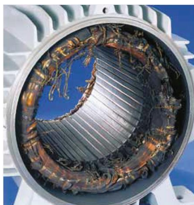
Figura 23 - Queima por sobrecarga térmica.
