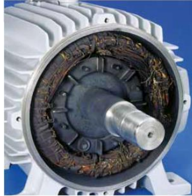
Figura 31 - Queima por rotor bloqueado.
