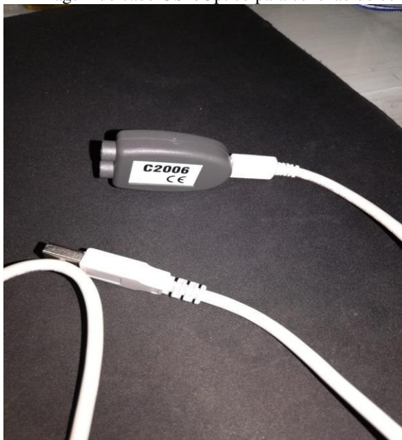
Figura 22 – Imagem do cabo USB/Óptico para conexão do computador
