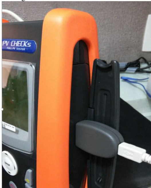
Figura 23 – Conexão do cabo USB/Ótico
