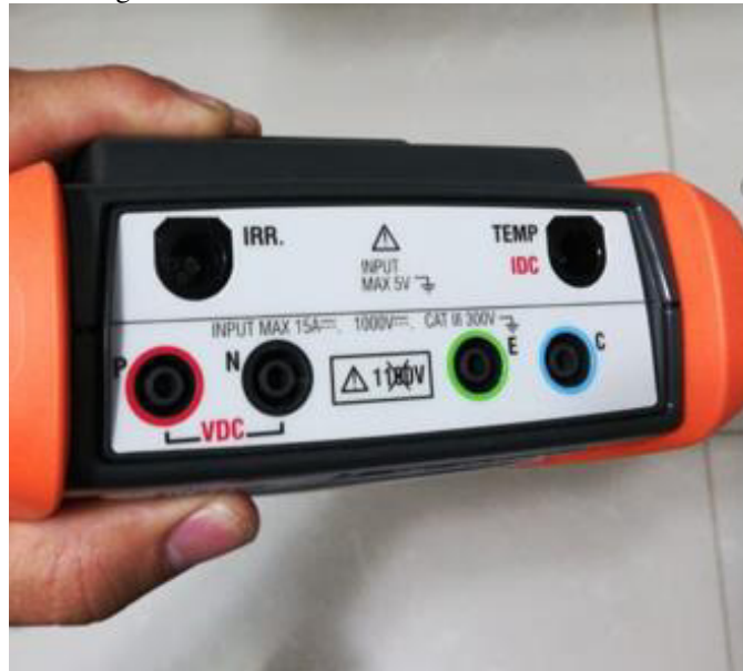
Figura 35 – Conexões de entrada do PVCHECKS
