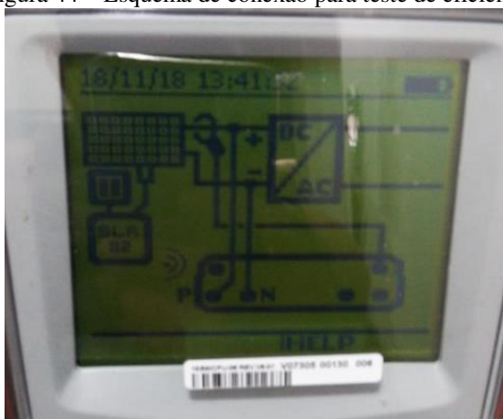
Figura 44 – Esquema de conexão para teste de eficiência
