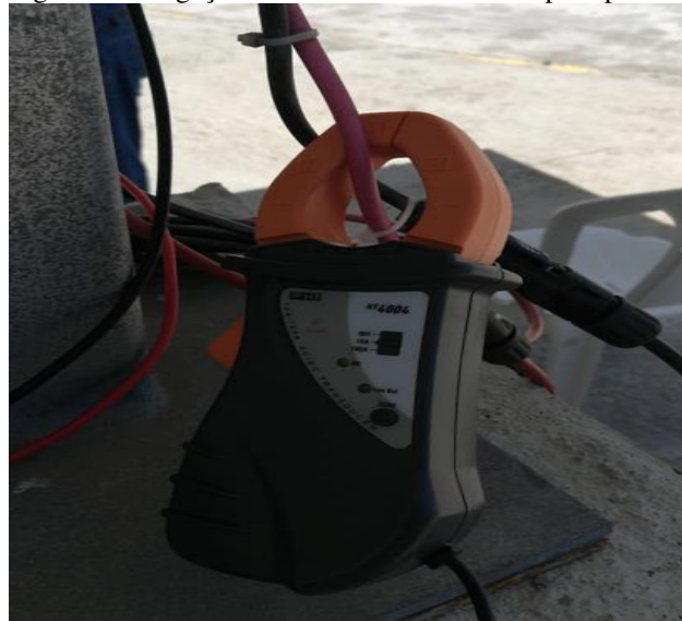
Figura 46 – Ligação do alicate de corrente no polo positivo
