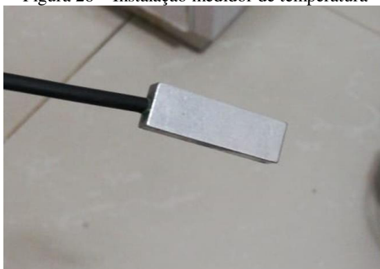
Figura 28 – Instalação medidor de temperatura
