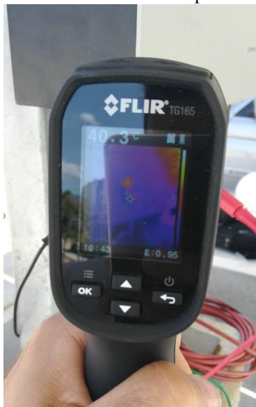
Figura 50 – Utilização da Câmera infravermelho para detecção de pontos quentes
