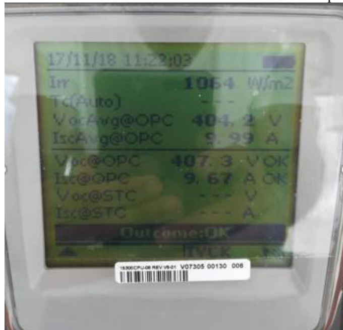
Figura 42 – Tensão de circuito aberto e corrente de curto circuito operacionais
