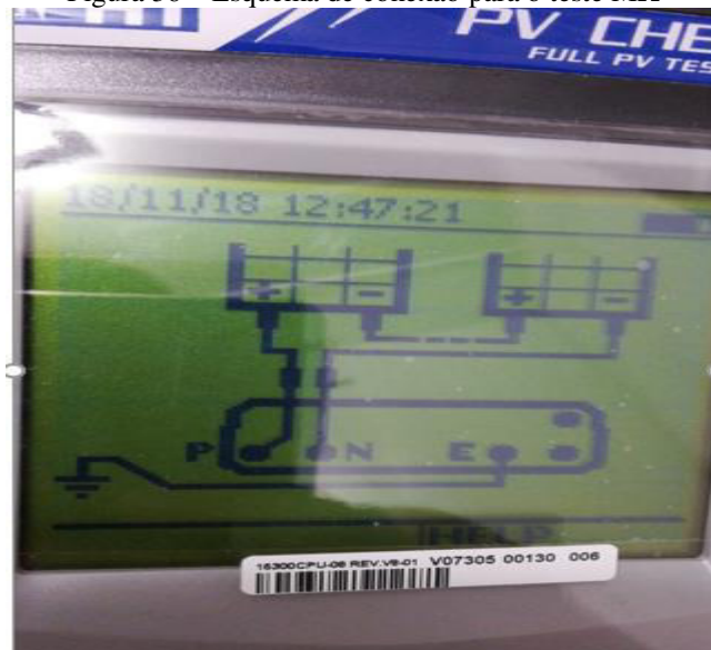
Figura 36 – Esquema de conexão para o teste M\Omega
