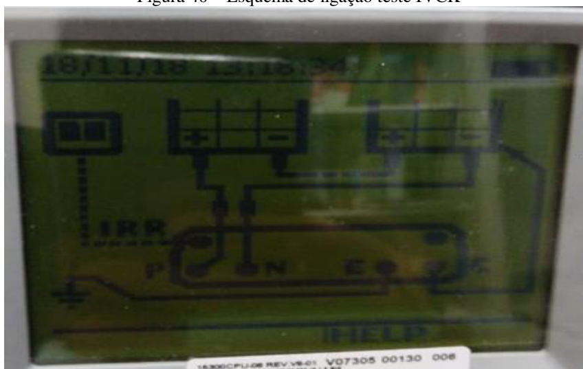
Figura 40 – Esquema de ligação teste IVCK
