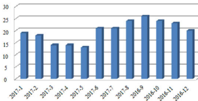
Figura 49 – Dados do Fator de Capacidade de uma planta FV de 1,5 kWp conectada à rede instalada em Fortaleza-CE
