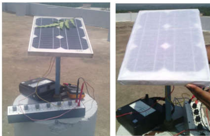
Figura 8 – Painel FV sob condições de sombreamento não-uniforme e uniforme
