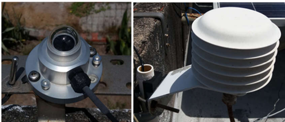
Figura 43 – Sensoriamento ambiental: Piranômetro LP02 (esquerda) e PT100 (direita)
