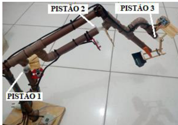
Figura 06 – Escavadeira feita de materiais plásticos.
