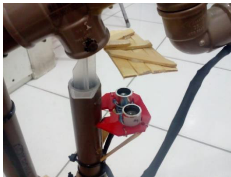
Figura 09 – Sensor responsável por ler o movimento do pistão 1.
