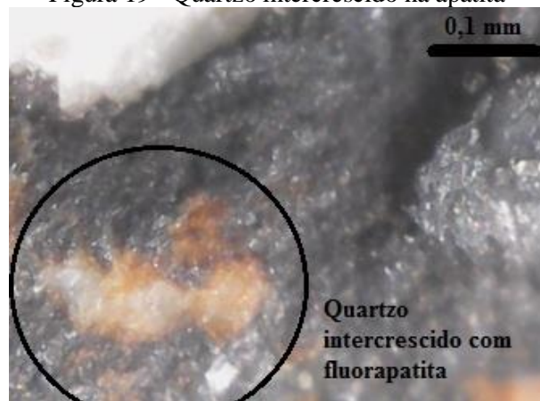
Figura 19 - Quartzo intercrescido na apatita
