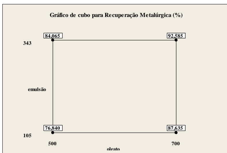
Figura 60 - Variação de recuperação metalúrgica para variação de oleato e emulsão
