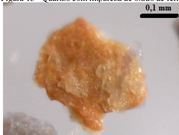
Figura 15 - Quartzo com impureza de óxido de ferro
