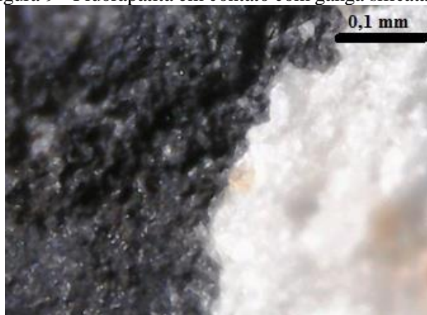
Figura 9 - Fluorapatita em contato com ganga silicatada
