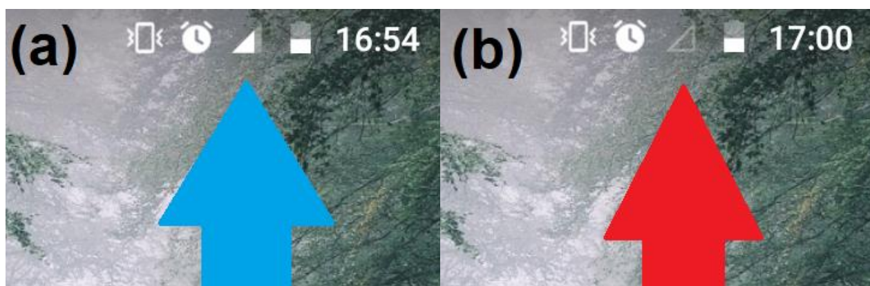
Figura 27: Resultado do experimento 5. (a) Presença de sinal no celular fora do papel alumínio. (b) Ausência de sinal no celular dentro do papel alumínio.
