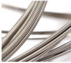
Figura 57 - Para que uma corda que produza uma frequência mais baixa sem aumentarmos seu comprimento, enrolar-la-á com um fio para ela ficar mais grossa, dando esse aspecto de "mola".
