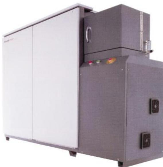
**Figura 9.** Espectrômetro utilizado para análise e registro de composição química do aço.
