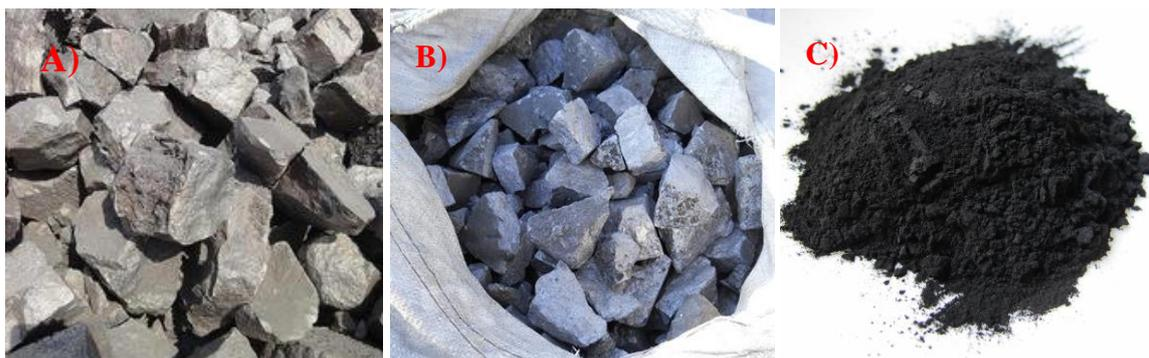
**Figura 8.** Ferro-ligas utilizadas. A) Ferro-Silício-Manganês. B) Ferro-Silício 75. C) Grafite.
