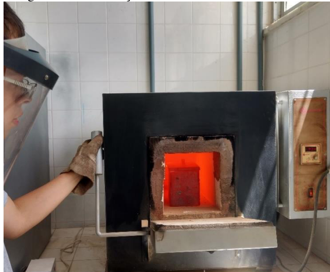
Figura 9. Caixa de aço colocada em forno mufla a 920^\circ\text{C}
