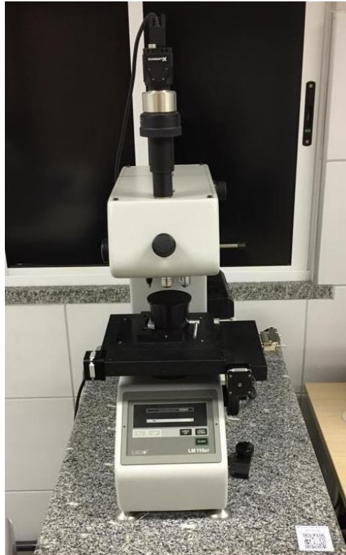
Figura 13. Equipamento utilizado para realização dos ensaios de microdureza.
