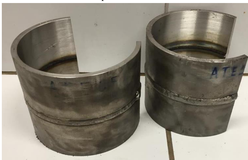
Figura 9. Tubos AISD UNS 32750 soldados com energias de 0,5 kJ/mm e 1,0 kJ/mm, respectivamente.
