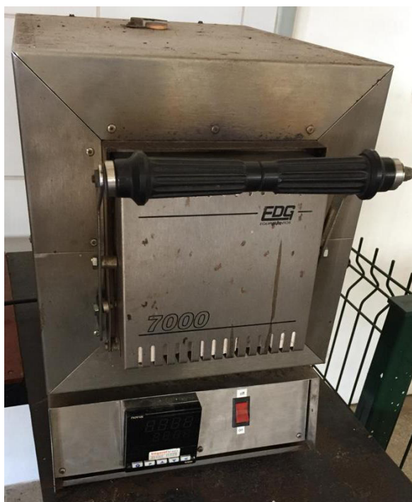
Figura 11. Forno utilizado para a realização dos tratamentos térmicos nas amostras.
