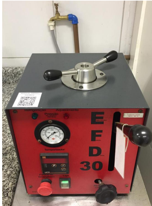
Figura 12. Equipamento utilizado para embutimento das amostras.
