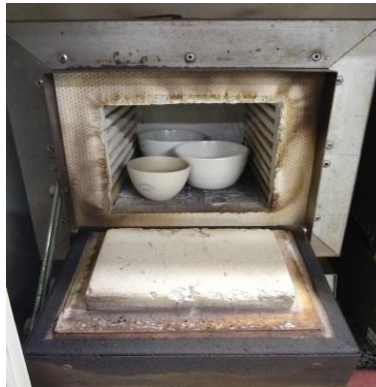
Figura 13 – Forno mufla com cadinho contendo as amostras 1, 2 e 3
