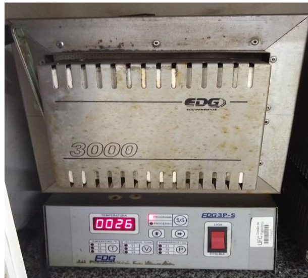
Figura 11 – Forno mufla do modelo EDG 3000 utilizado no tratamento térmico das amostras
