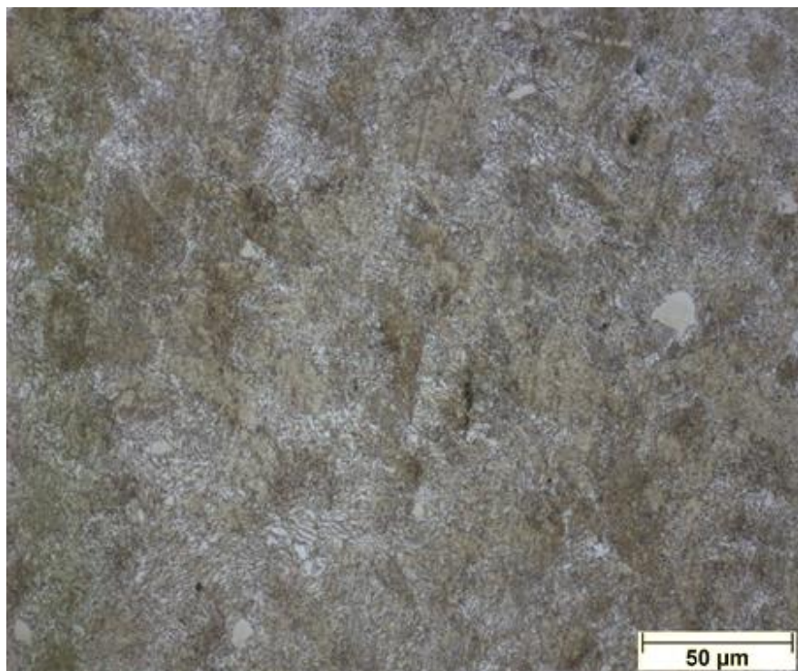
Figura 20 – Micrografia ótica em 500x da amostra AT-06. Identifica-se uma matriz perlítica com inclusões (em preto) e pequenos grãos não revelados (martensita). Ataque: Nital 2%.
