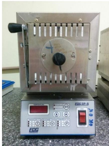
Figura 9 – Forno EDG 3P-S utilizado na austenitização das amostras.
