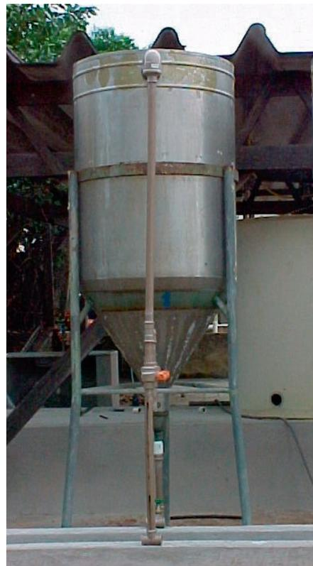
Figura 2: Vista externa do filtro anaeróbio.
