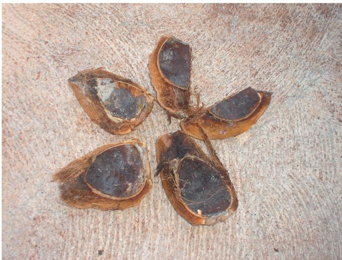
**Figura 4:** Detalhe das cascas de coco verde da espécie *Cocos nucifera* utilizadas no leito do reator anaeróbio.
