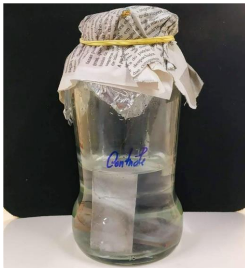
Figura 11 - Eletrodos de cobre e alumínio imersos em caldo MFC sem inóculos bacterianos.
