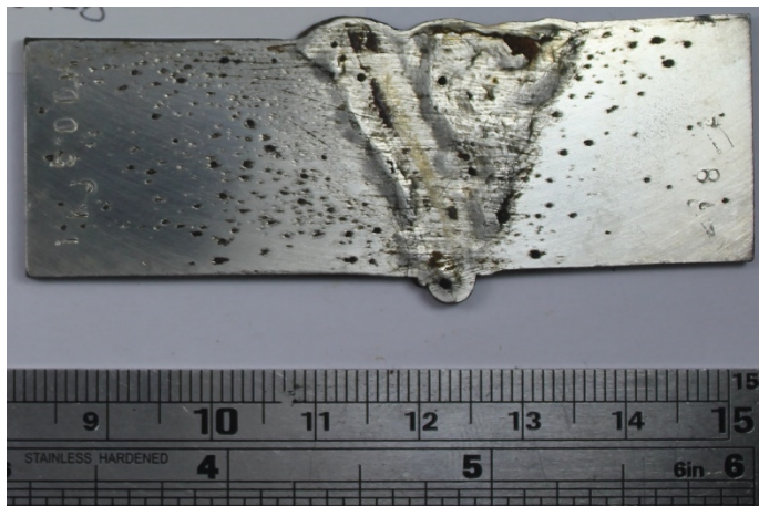
Figura 138: Comportamento corrosivo da amostra soldada 1,0 kJ/mm e tratada por 200 horas após ensaio da ASTM G48
