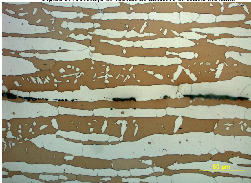
Figura 39: Presença de cadeias na interface da ferrita/austenita
