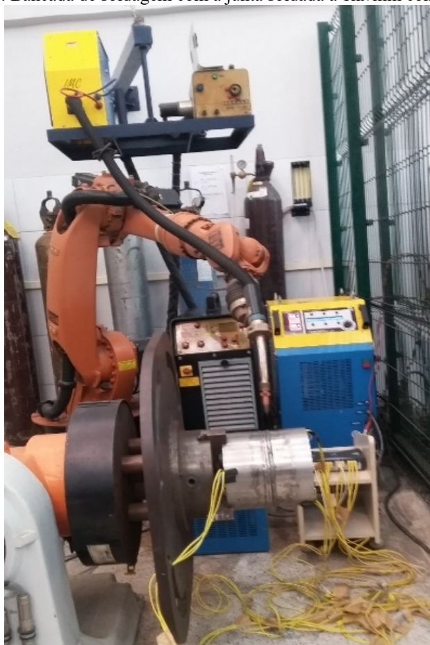
Figura 27: Bancada de soldagem com a junta soldada a 1kJ/mm com termopares
