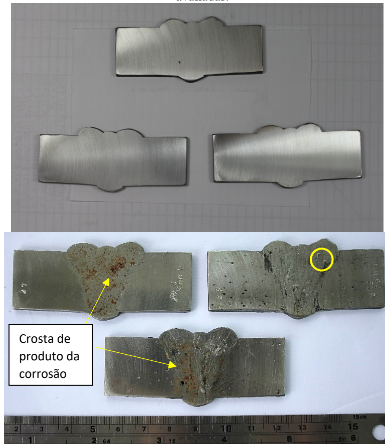
Figura 139: Amostras soldadas a 2,0 kJ/mm pós ensaio G48 no tempo de 500 horas para as energias avaliadas.
