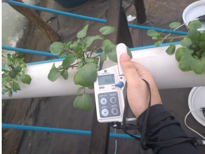
Figura 8- Análise de clorofila com o equipamento SPAD.
