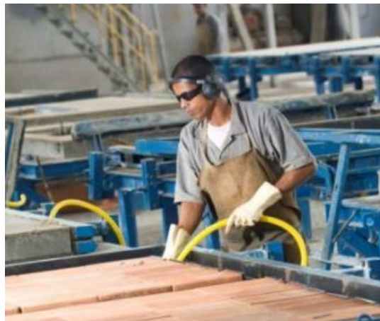
Figura 111 – Instalação de eletrodutos nos furos dos blocos cerâmicos na forma dos painéis do sistema PRECON
