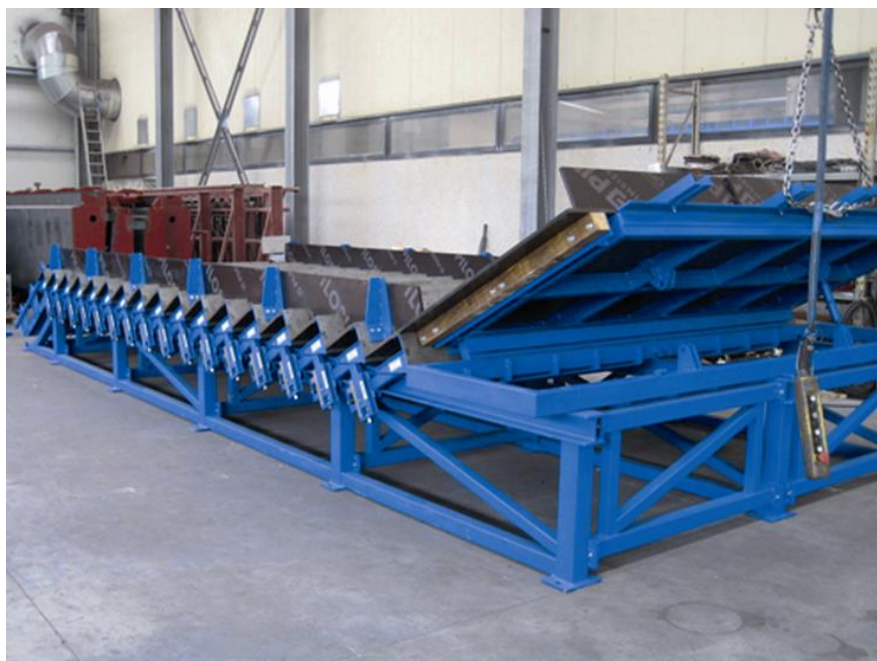
Figura 8 – Forma metálica para fabricação de escada pré-fabricada
