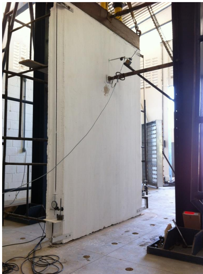
Figura 153 – Instrumentos de medição de encurtamentos laterais e deslocamentos e seus dispositivos de suporte
