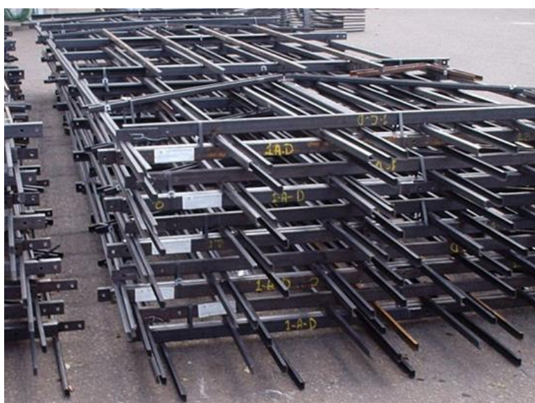
Figura 16 – Perfis metálicos soldados para estrutura de cobertura pré-fabricada
