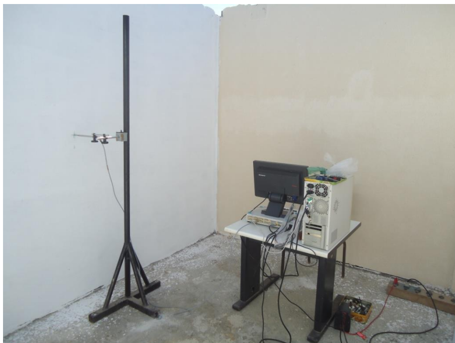
Figura 161 – Esquema de ensaio de corpo mole pelo lado do painel oposto ao do impacto
