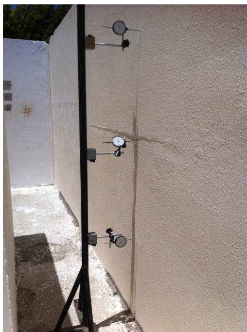
Figura 168 – Relógios para medição dos deslocamentos durante o ensaio de peças suspensas
