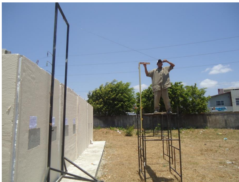
Figura 164 – Esquema de ensaio de impacto de corpo duro
