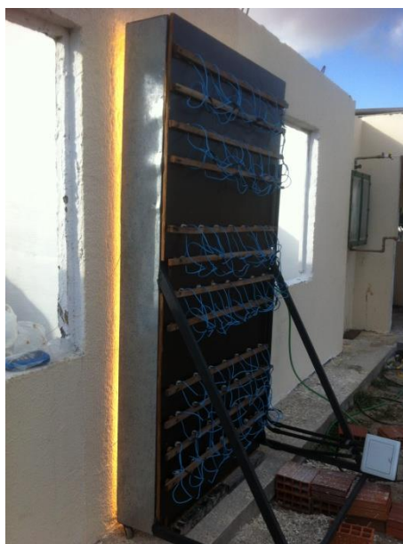
Figura 176 – Esquema de ensaio de ação de calor e choque térmico
