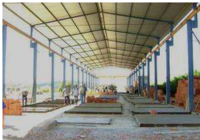
Figura 50 – Vista geral de unidade de produção do sistema CASA EXPRESS em Itapira-SP
