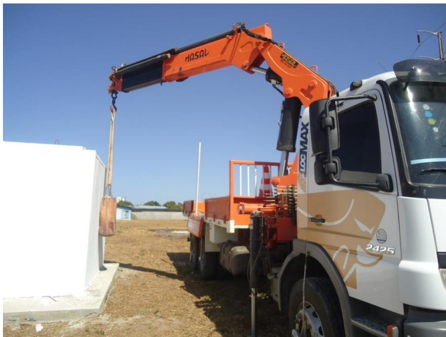
Figura 160 – Esquema de ensaio de corpo mole pelo lado do painel que recebe o impacto
