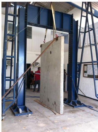
Figura 149 - Pórtico e laje de reação do NUTEC
