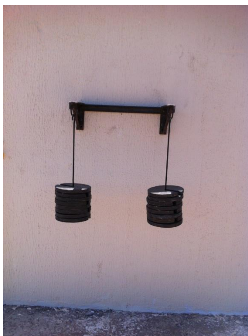
Figura 170 – Ensaio de mão francesa com pesos metálicos para aplicação da carga
