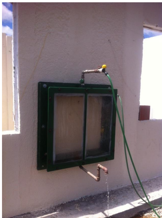
Figura 174 – Esquema de ensaio de estanqueidade à água
