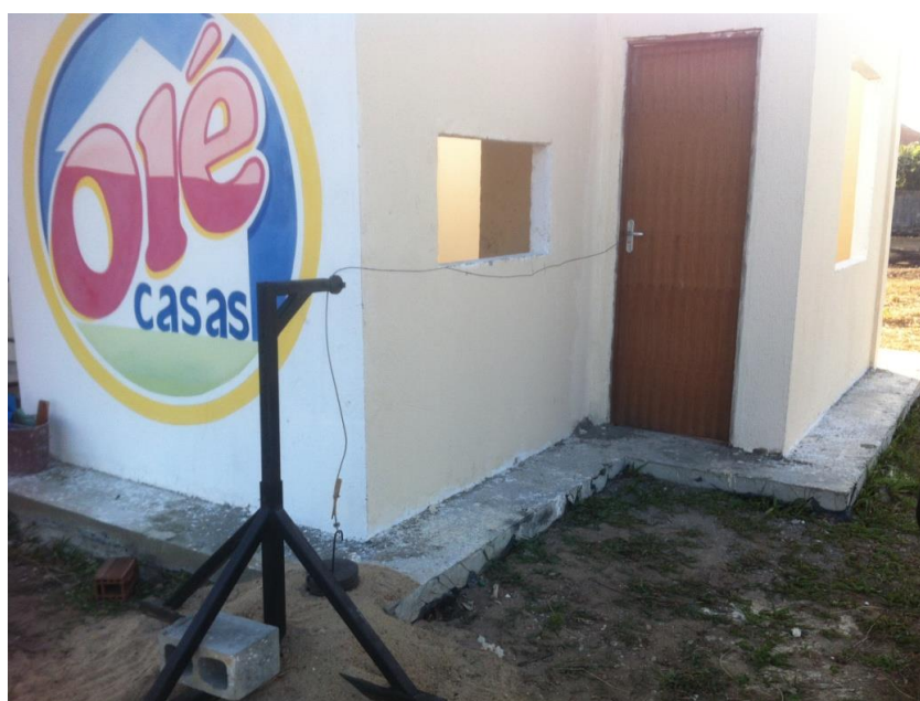
Figura 171 – Esquema de ensaio de verificação das ações transmitidas por impacto de portas
