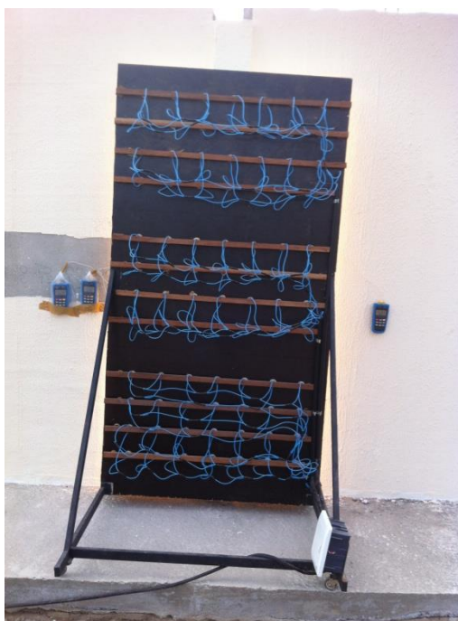
Figura 177 – Esquema de ensaio de ação de calor e choque térmico na ligação pilar-painel
