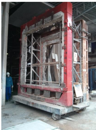
Figura 180 – Pórtico para posicionamento do corpo de prova do ensaio de resistência ao fogo no IPT
