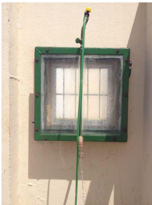
Figura 175 – Esquema de ensaio de estanqueidade para avaliação da interface painel-esquadria
