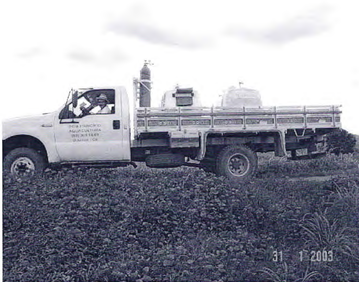
FIGURA 8 Caminhão com cilindros de oxigênio e caixas “transfish” usado no transporte dos alevinos para os viveiros, na Fazenda Bom Princípio, Município de Guaiuba, CE.
