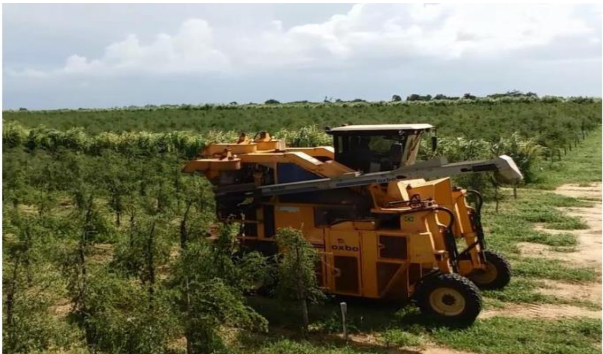
Figura 4 – Máquina de colher oliva, adaptada a colheita da acerola na linha de plantio da cultura
