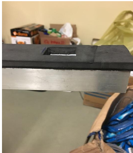
Figura 9 -- Barra revestida com borracha
