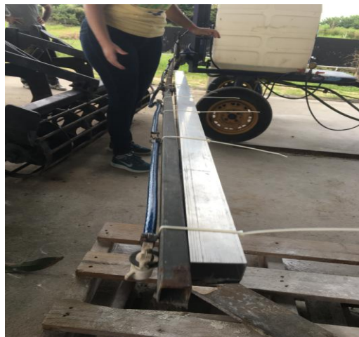
figura 12 -- Barra de alumínio fixada junto a barra de pulverização.
