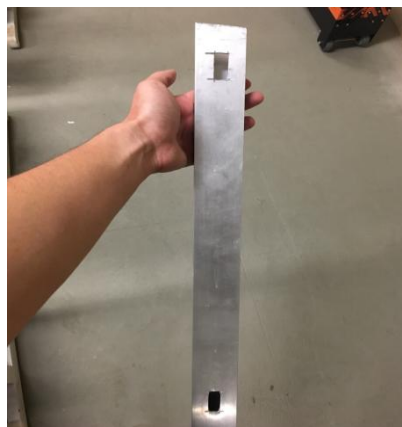
Figura 8 – Recortes realizados na barra de alumínio
