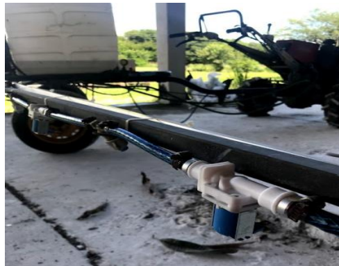
Figura 13 -- Detalhe das válvulas solenóides
