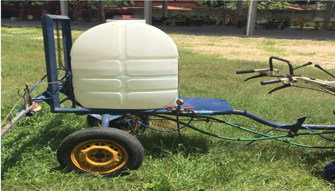
Figura 12 - Tanque de armazenamento do produto a ser utilizado na pulverização
