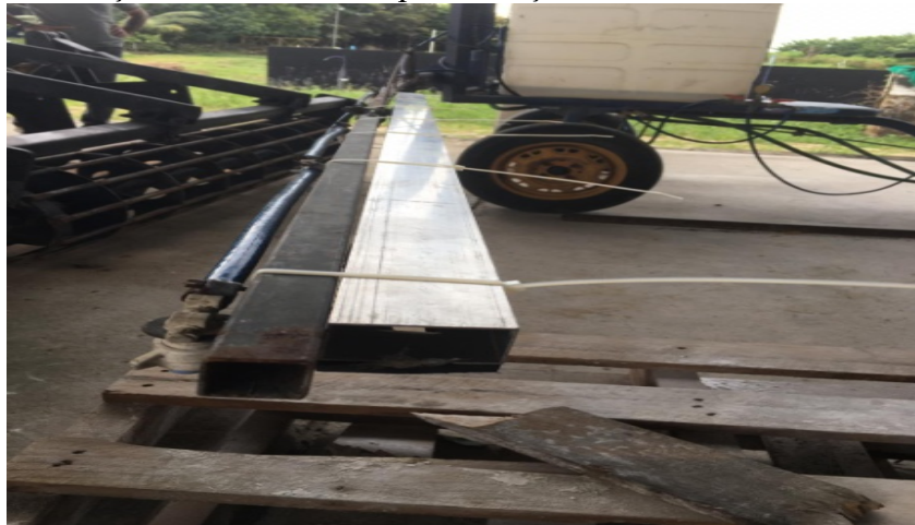
Figura 8 - Barra de ferro envolta a borracha e fixada com auxílio de abraçadeiras na barra de pulverização
