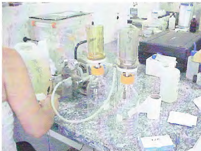
Figura 09 – Material utilizado na filtração das amostras recém chegadas ao laboratório.
