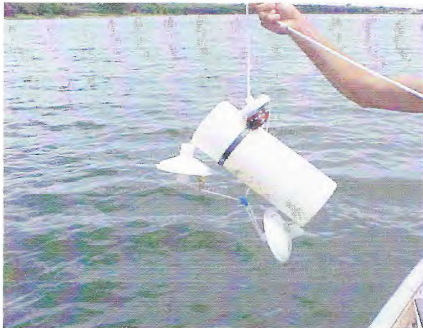
Figura 08 – Garrafa de Van Dorn utilizada na coleta de água em diferentes profundidades.
