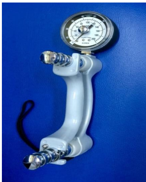
Figura 06 - Dinamômetro hidráulico manual, SH5001 (SAEHAN Corporation, Korea).
