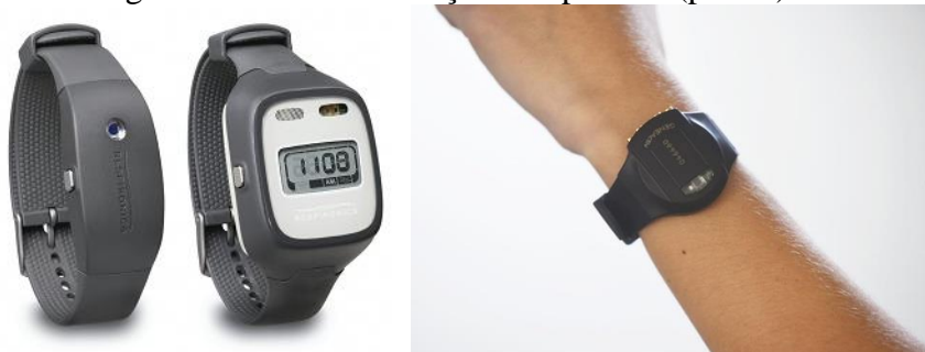
Figura 5 – Actígrafo e local de colocação do aparelho (punho).
