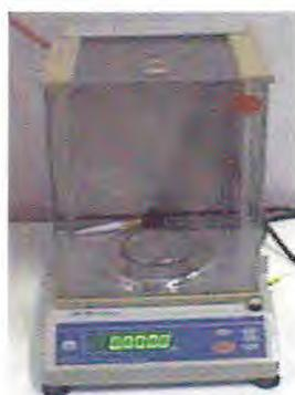
Figura 5 – Balança analítica usada para pesagem das amostras.
