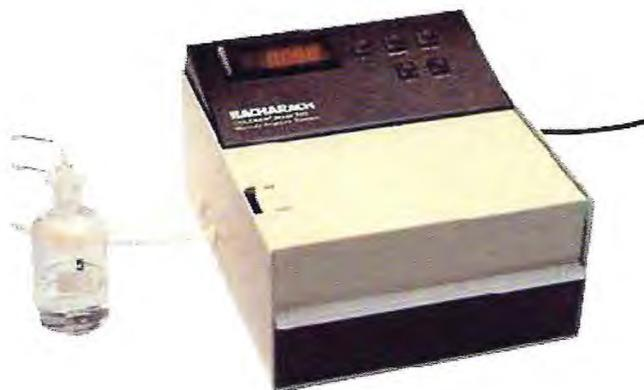
Figura 6 – Equipamento para determinação de mercúrio, usando a técnica de espectrofotetria de vapor frio (BACHARACH, 1994).
