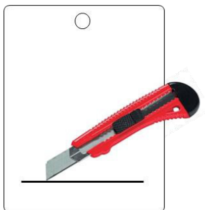
Figura 9 - Ilustração da incisão feita na parte inferior da chapa até atingir o substrato.
