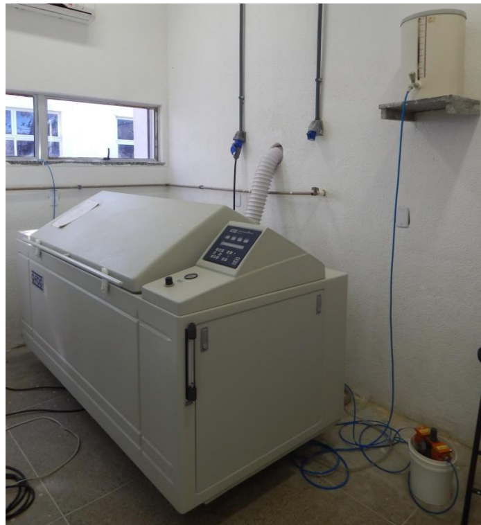
Figura 11 - Imagem da câmara de ensaio acelerado de névoa salina utilizada no presente trabalho.
