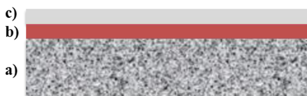
Figura 7 - Esquema de pintura utilizada para transformadores padrões, (a) aço carbono SAE 1020, (b) tinta primer na cor vermelho escuro e (c) tinta de acabamento na cor cinza claro.
