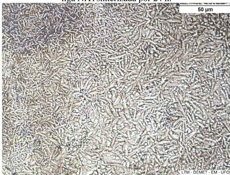
Figura 66 – Micrografia óptica em 500x da liga NiTi sinterizada por 24 h.
