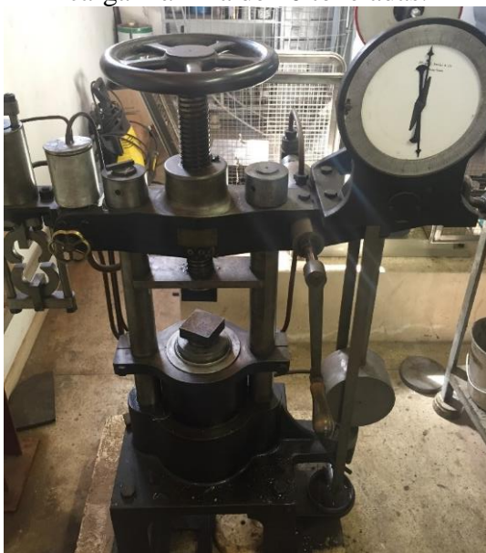
Figura 37 – Prensa hidráulica com carga máxima de 20 toneladas.
