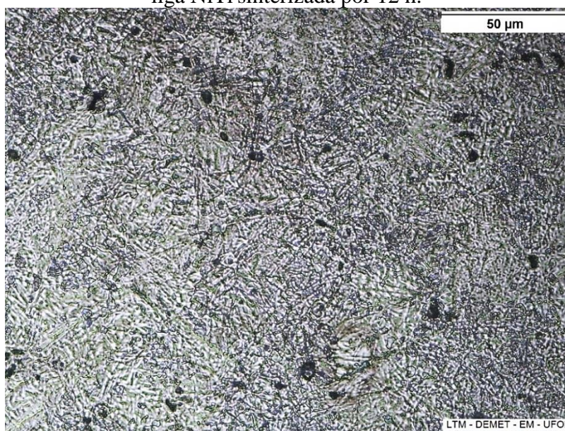
Figura 63 – Micrografia óptica em 500x da liga NiTi sinterizada por 12 h.
