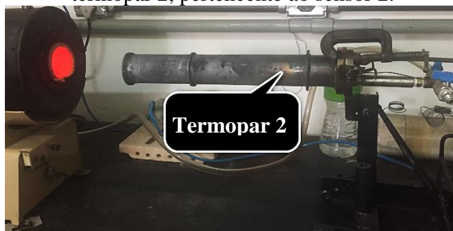
Figura 42 – Estrutura do forno com a indicação do termopar 2, pertencente ao sensor 2.
