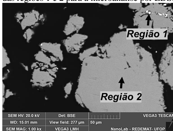
Figura 51 – Micrografia da partícula de pó de Ti obtida pelo MEV (1000x) com a indicação das regiões 1 e 2 para a microanálise por EDS.
