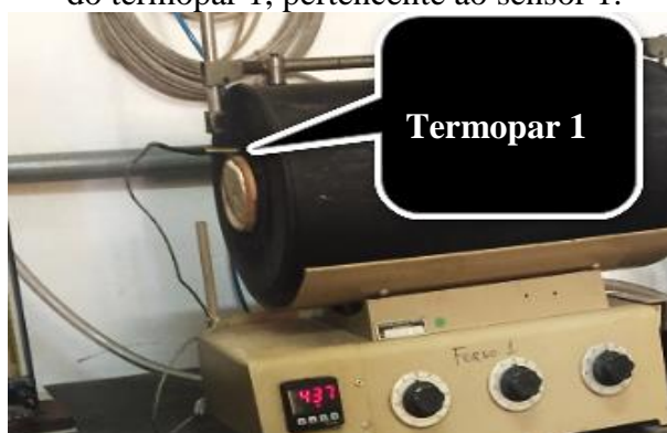
Figura 41 – Estrutura do forno com a indicação do termopar 1, pertencente ao sensor 1.
