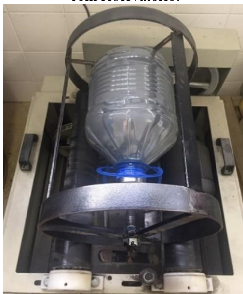
Figura 36 – Misturador a baixa energia com reservatório.
