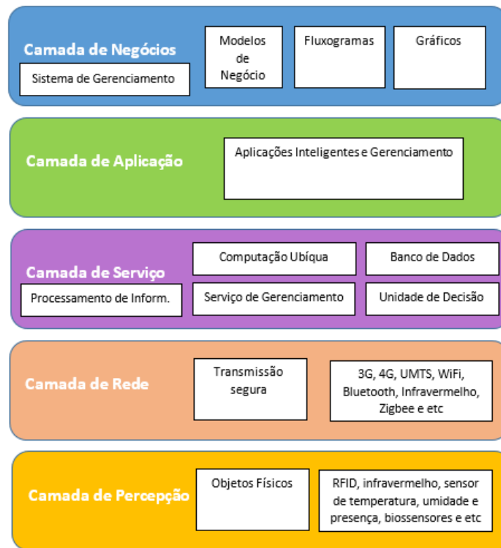
Figura 6 – Arquitetura em camadas para IoT.
