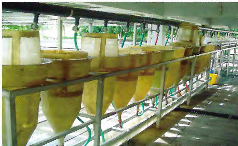
FIGURA 36. Incubadoras de 60l utilizadas para a estocagem dos ovos de tambaqui, C. macropomum , no CPAq Rodolpho von Ihering, Pentecoste – CE.
