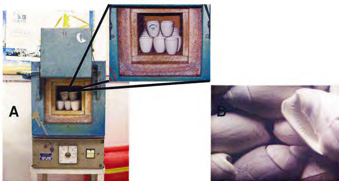
Figura 4: A: Cadinhos dispostos no interior da Mufla; B: Indivíduos de Olivella minuta após a queima em Mufla.
