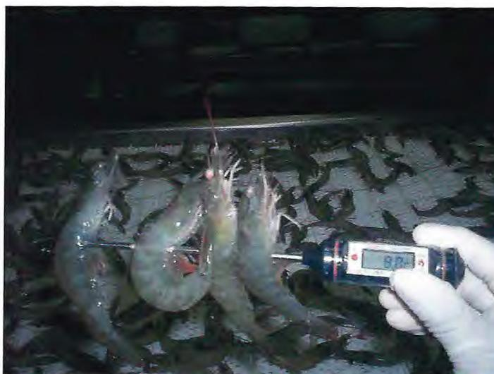
Figura 5 - Termômetro digital utilizado no beneficiamento do camarão na indústria R&B.
