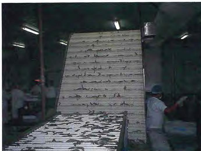
Figura 7 Esteira elevatória da máquina classificadora da indústria R&B.
