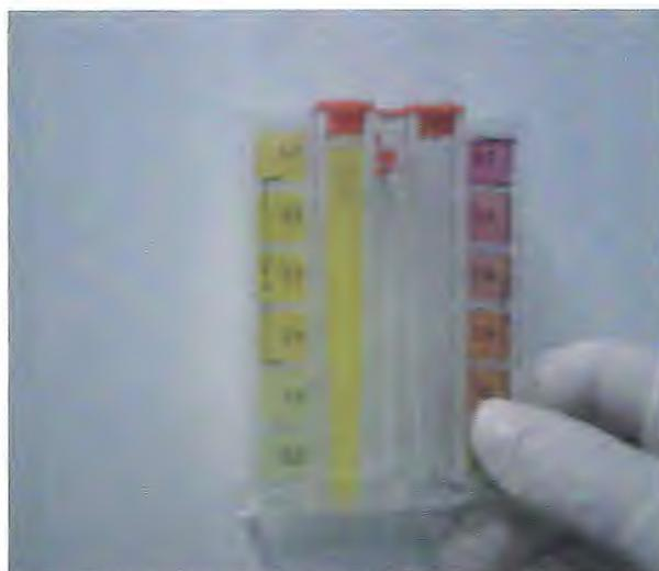
Figura 6 Teste da concentração de cloro da água utilizada no beneficiamento do camarão na indústria R&B .
