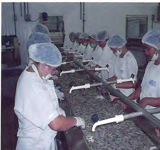
Figura 16 - Operárias na mesa semi-automática de dupla canaleta retirando manualmente o cefalotórax na indústria R&B.
