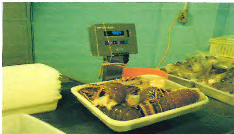
Figura 8 - Bandeja de plástico contendo cauda de lagosta sendo pesada através de balança eletrônica devidamente aferida, na indústria INTERFRIOS – Intercâmbio de Frios S/A, em Fortaleza, Ceará.
