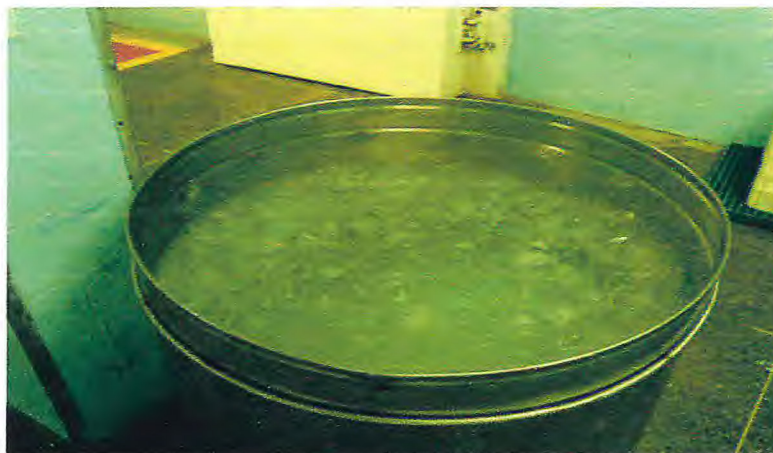
Figura 10 - Tanque de aço inox contendo solução de tripolifosfato e gelo na indústria INTERFRIOS – Intercâmbio de Frios S/A, em Fortaleza, Ceará.
