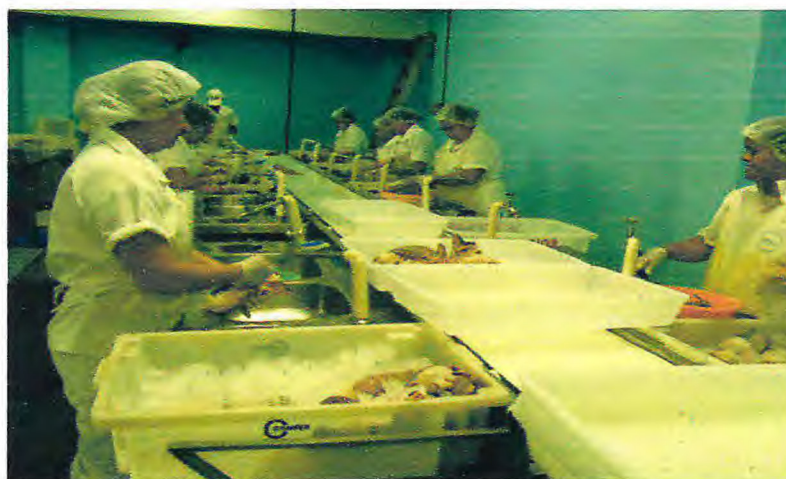
Figura 6 - Funcionárias dispostas ao longo da mesa semi-automática com disposição de uma esteira rolante para a realização das etapas de evisceração e “toillet” das caudas de lagosta, na indústria INTERFRIOS – Intercâmbio de Frios S/A, em Fortaleza, Ceará.
