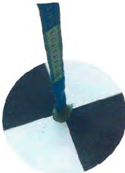
Figura 9 - Disco de Secchi, instrumento utilizado para medir a transparência dos viveiros de produção.
