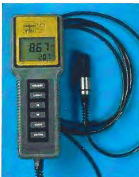
Figura 8 - Oxímetro utilizado para se determinar a quantidade de oxigênio dissolvido.
