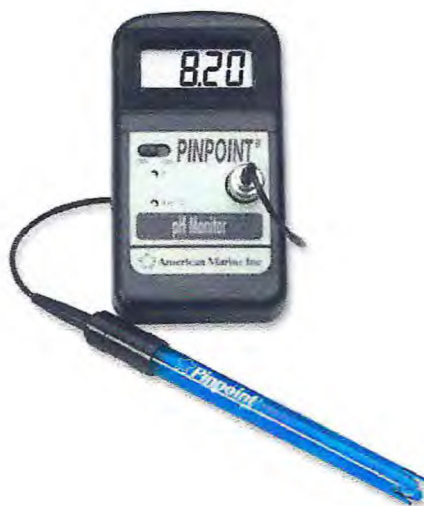
Figura 10 - Equipamento (pH-metro) utilizado para medir o pH dos viveiros de produção.
