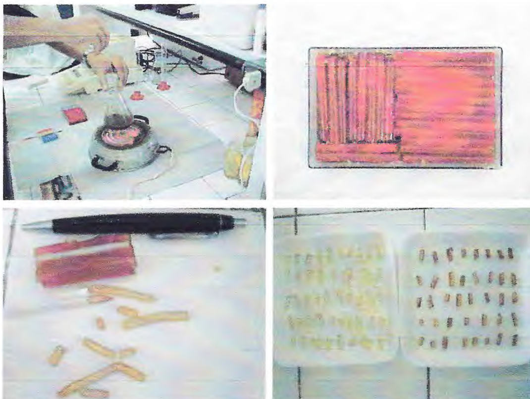
Figura 3. Aglutinação do ingrediente à gelatina. Peletes no formato cilíndrico foram obtidos através da adição de água a mistura de gelatina e ingrediente, seguido do aquecimento, agitação e resfriamento em temperatura de 4°C.
