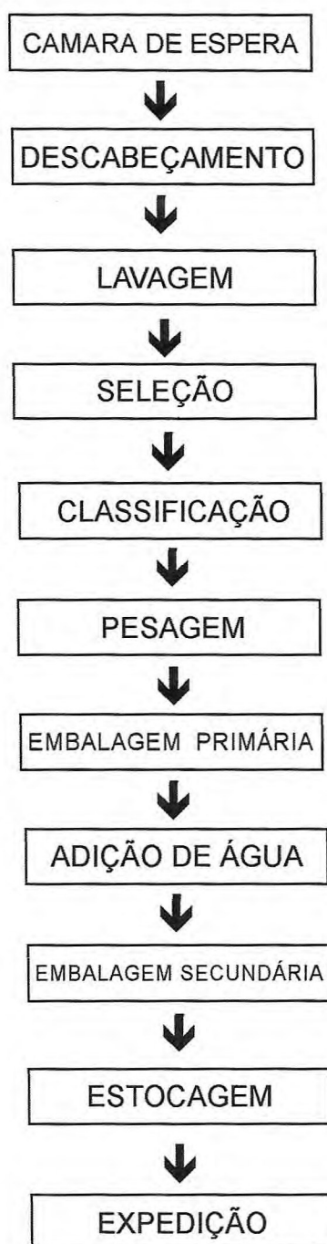
Figura 20 – Fluxograma do Beneficiamento do Camarão Sem Cabeça Congelado
