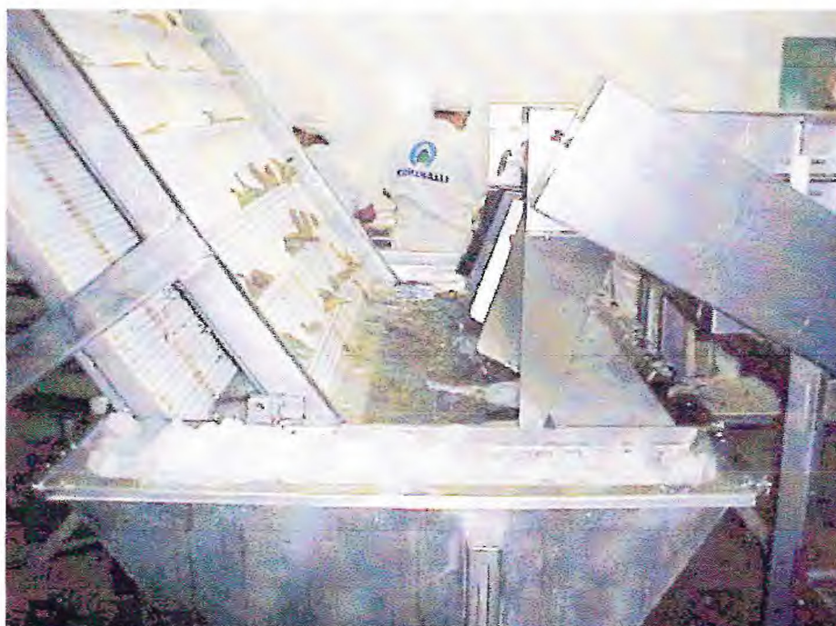
Figura 8 – Detalhe do tanque de aço inox, mostrando a direita a esteira de seleção e à esquerda a esteira elevatória
