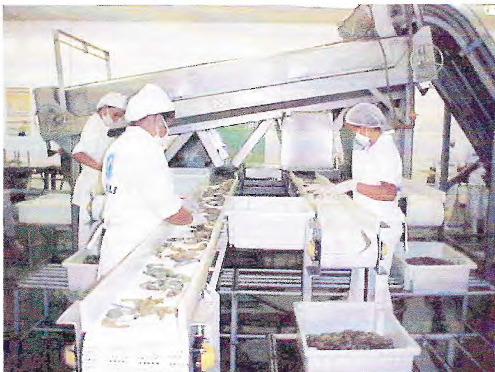
Figura 11 - Operárias treinadas realizando o trabalho de classificação manual para assegurar a uniformidade do produto
