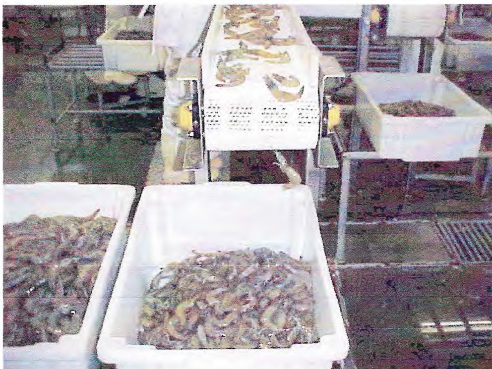
Figura 12 – Monoblocos plásticos com gelo onde caem os camarões após a classificação manual
