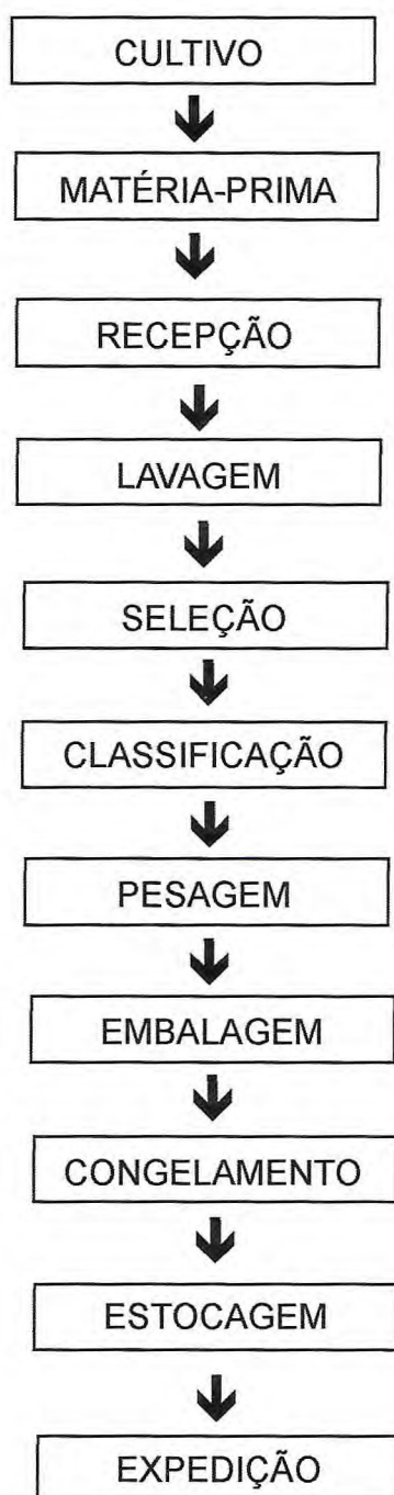
Figura 2 – Fluxograma do Beneficiamento do Camarão Inteiro Congelado realizado pela Empresa COMINALLI
