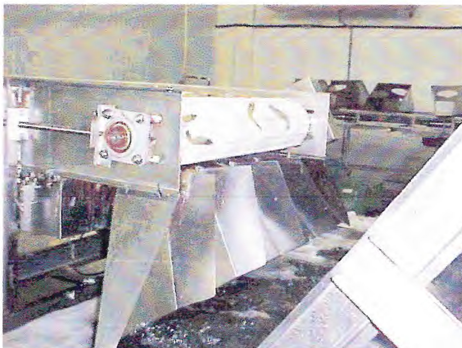
Figura 7 – Extremidade da esteira de seleção mostrando os camarões caindo no tanque de aço inox
