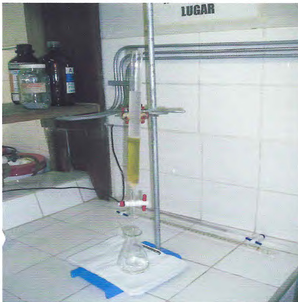
FIGURA 3 – Aparentagem para separação das classes de lipídios totais
