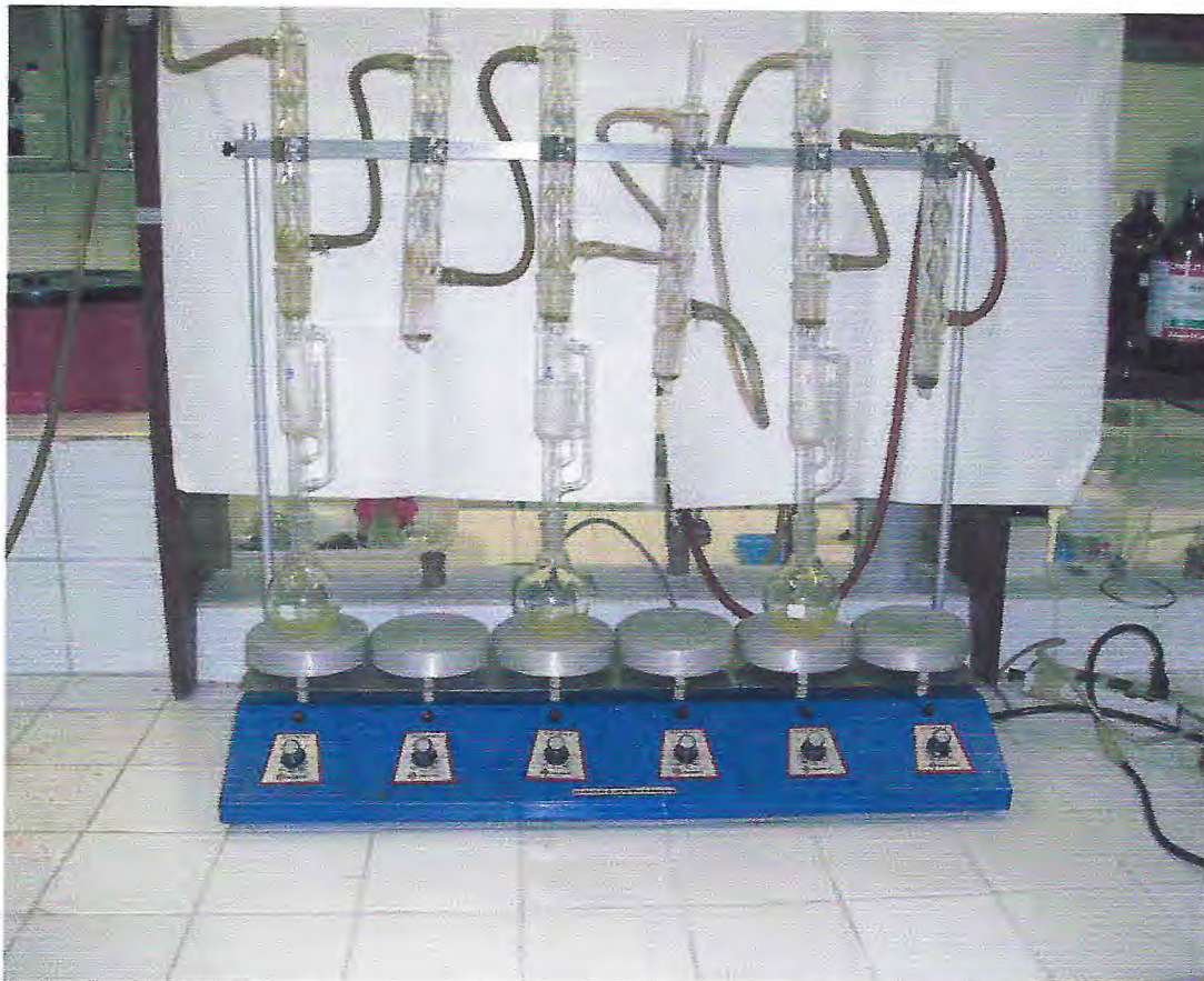
FIGURA 1 – Aparelhagem para extração de lipídios totais pelo método de Soxhlet.
