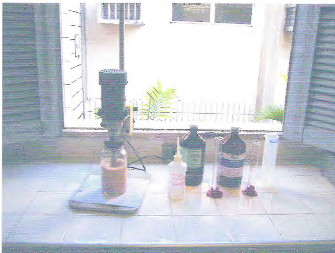
FIGURA 2 – Aparelhagem para extração de lipídios totais pelo método de Bligh & Dyer (1959).
