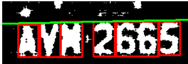
Figura 39 – Resultado de uma regressão linear aplicada nas posições dos caracteres
