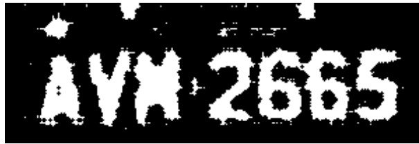
Figura 37 – Imagem resultante de um fechamento em uma imagem binarizada de placa
