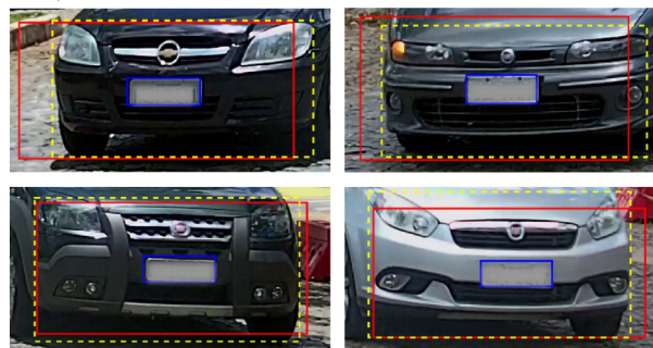
Figura 20 – Ilustração da visão frontal (VF): o retângulo amarelo tracejado representa uma VF marcada manualmente enquanto o retângulo vermelho é a VF estimada baseada na placa (em azul)
