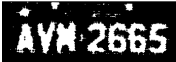
Figura 40 – Imagem binária de placa com inclinação corrigida
