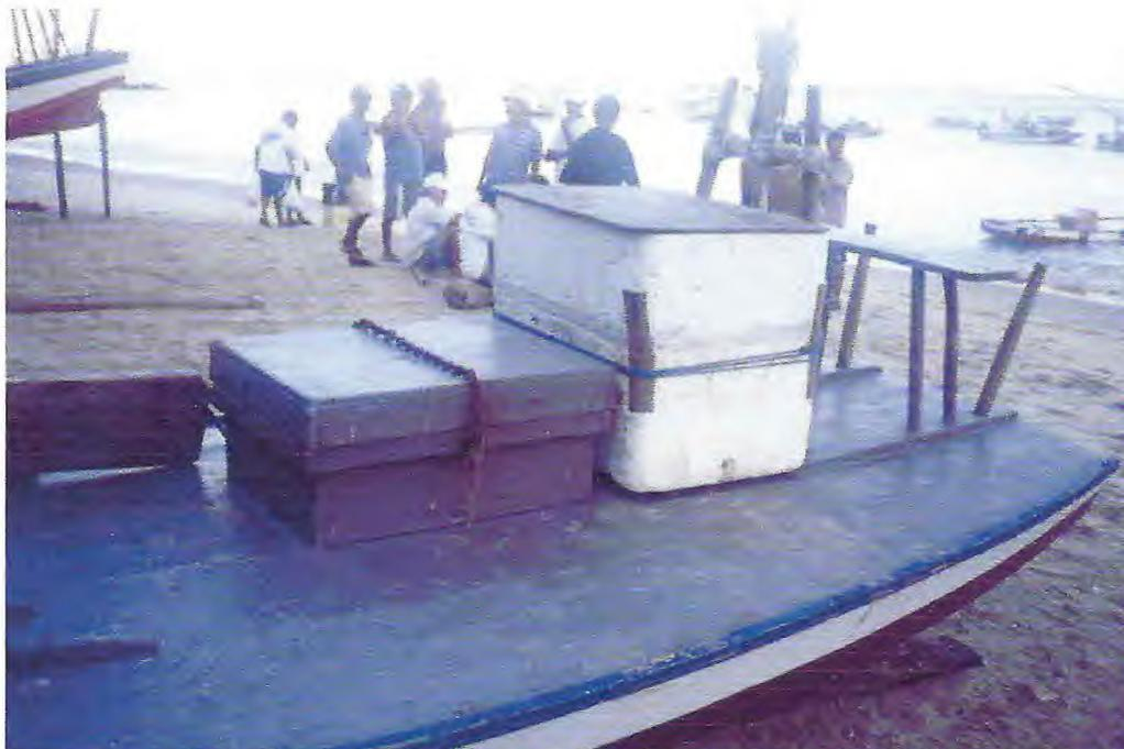
**FIGURA 06** – Tipo de caixa de armazenamento do pescado e sua localização na embarcação.
