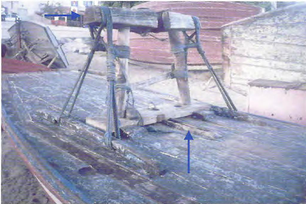
**FIGURA 05** – Vista da popa da embarcação evidenciando a fenda da bolina e o banco de vela.
