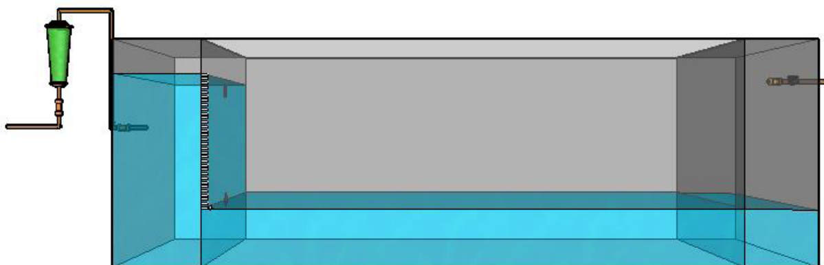
Figura 4 - Aparato instrumental para a determinação da perda de carga.
