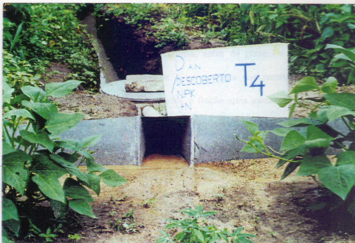
Figura 5. Comparação do acúmulo de sedimentos nas calhas coletoras dos tratamentos MA e DAN.
