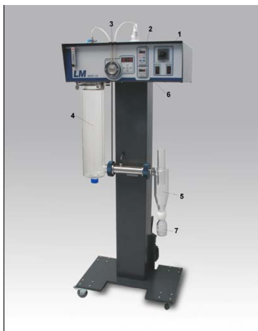
Figura 6.2. Fotografia do MSD 1.0 (Labmaq) e seus sistemas principais: 1) Chave geral 2) Controle do aquecimento; 3) Controle de bombeamento de líquido; 4) Câmara de secagem 5) Separador de pó seco 6) indicador de temperatura de saída do produto e 7) Frasco coletor do pó seco.
