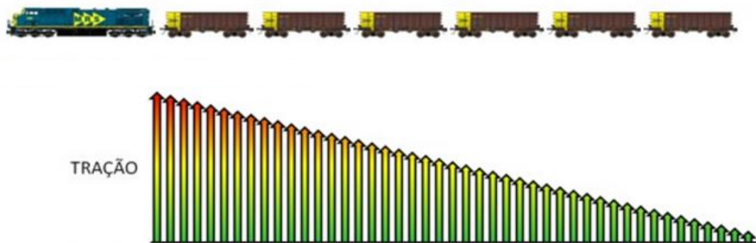
Figura 3 - Configuração do trem com tração na cabeça e os esforços nos engates (Fonte: MRS, 2017)
