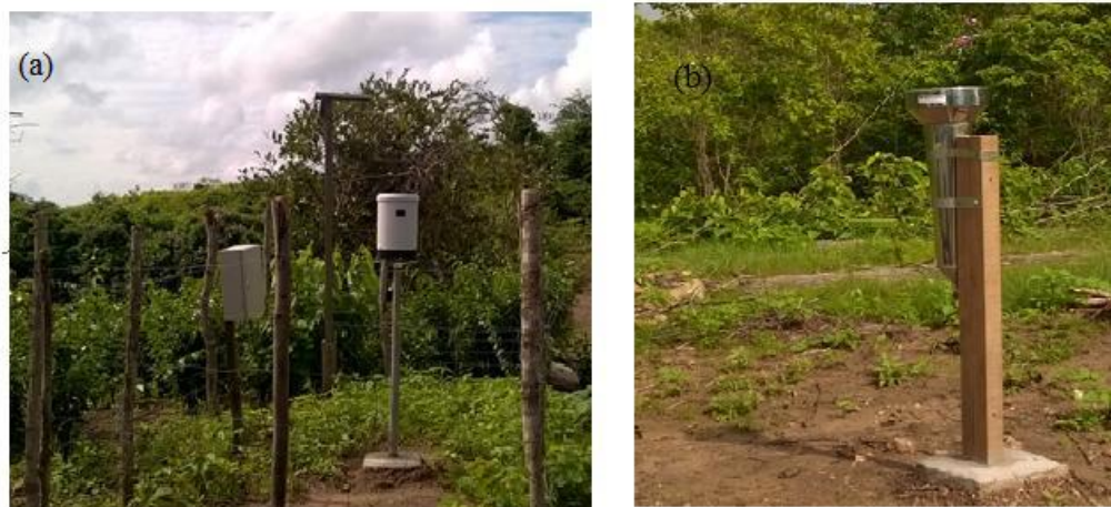
Figura 6 - Equipamentos para monitoramento pluviométrico da BEVC.
