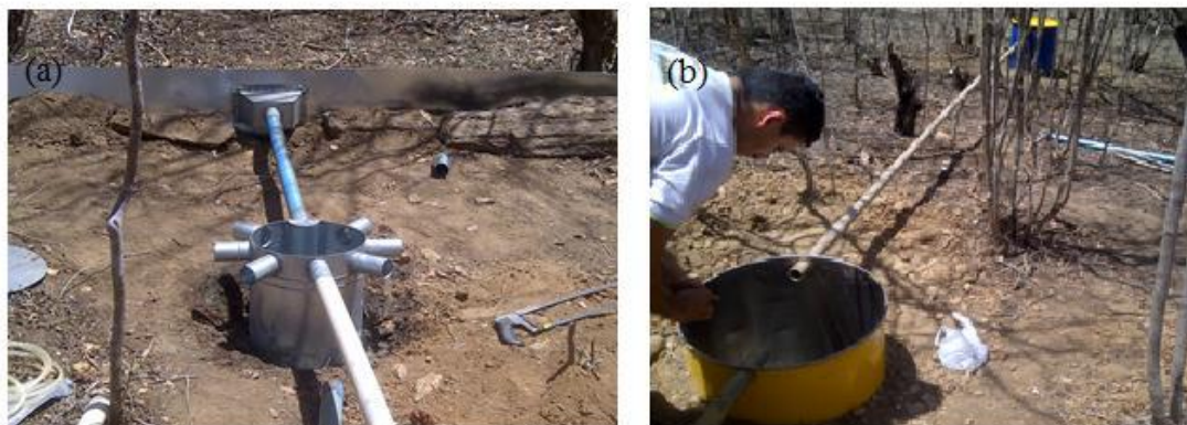
Figura 10 - Tanques coletores de água e sedimento.
