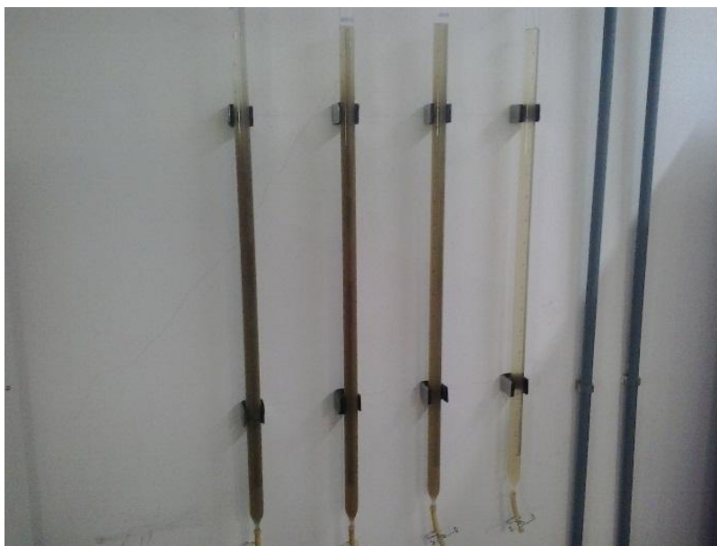
Figura 11 - Tubos utilizados no método Tubo de Remoção pela Base.
