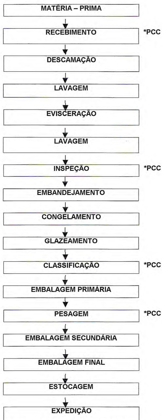
Figura 10 - Fluxograma de Beneficiamento do peixe inteiro eviscerado congelado .
